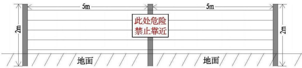
图 2-1-1 网围栏及警示牌示意图
