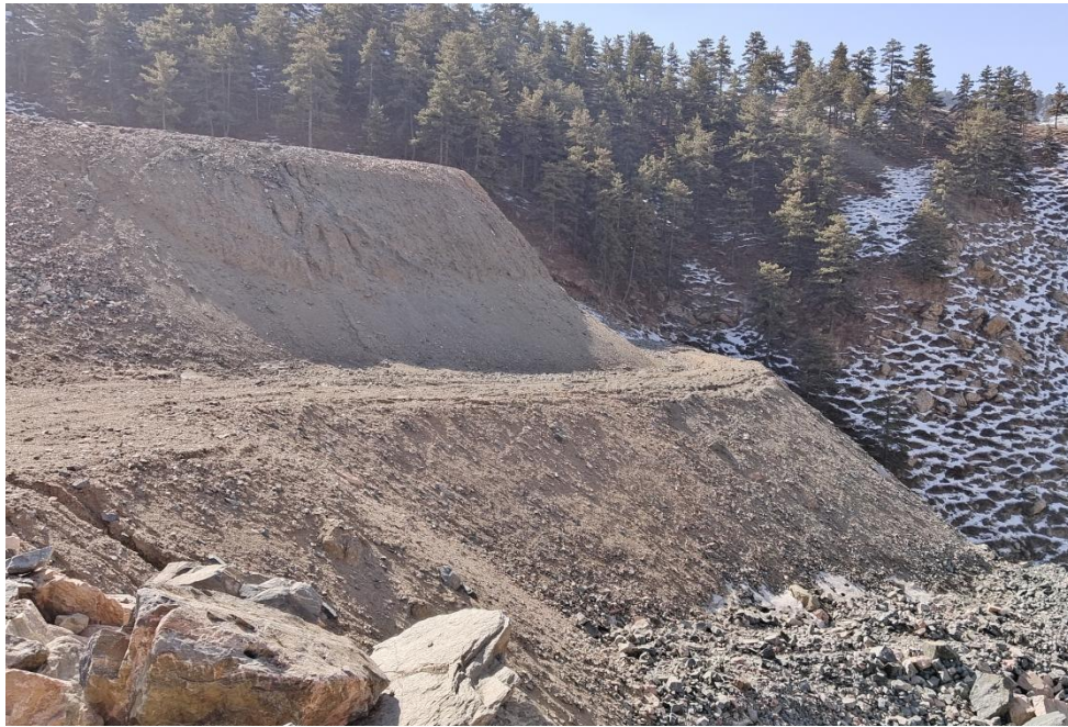
照片 2-3 一采区露天采场 CK2 边坡废石台阶
