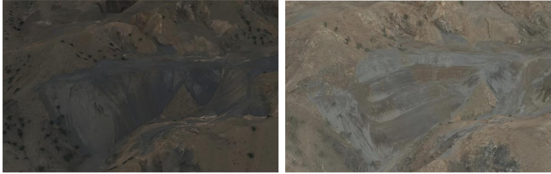
照片 2-9 废石堆边坡整形、覆土、平整、恢复植被（治理前后对比图）
